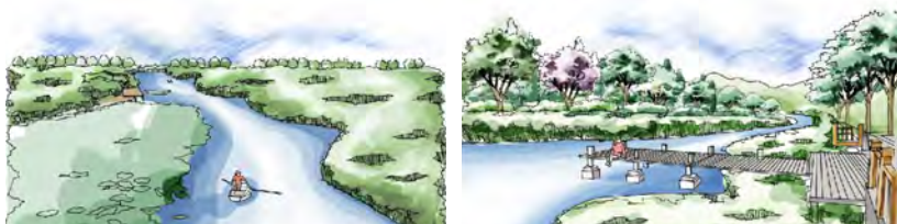
a) 生态驳岸采取自然适生植物护坡
