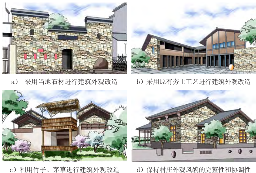
图 6 建筑外观整治
